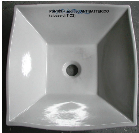
Foto 1 – Lavabo prodotto con impasto SANITSER 13 e smalto PSI-109 con additivo antibatterico
