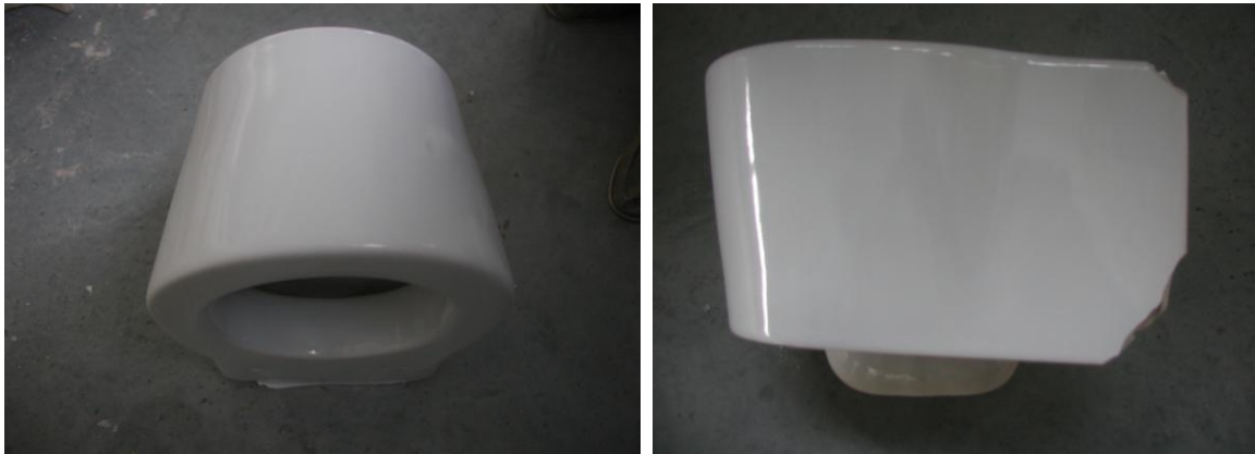
Test di smaltatura con due differenti formulazioni di smalti studiate da GEMICA.
